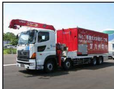
移動式大容量ポンプ車
