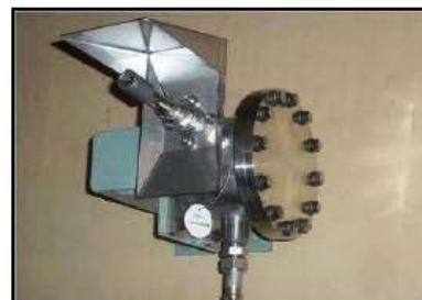
電気式水素燃焼装置
